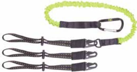
Unsere Werkzeugsicherung verfügt über drei austauschbare Werkzeugenden an 25-cm-Schlaufen aus Gewebeband, an denen Kordelstopper mit zwei Löchern angebracht sind. HK-Karabiner sorgen für einen schnellen Werkzeugwechsel. Ein robuster Karabinerhaken und eine praktische Schlaufe aus Gewebeband zur Befestigung am Gürtel runden die Funktionen ab. Für Werkzeuge bis 2,5 kg ausgelegt.
