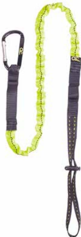
Unsere Werkzeugsicherung besteht aus 19-mm-Gewebeband mit Expanderseil im Inneren und ist bis 140 cm dehnbar. Es ist mit einem robusten Karabinerhaken, einer 25-cm-Gewebebandschlaufe, einem Zwei-Loch-Kordelstopper und einer Gewebebandschlaufe zur Befestigung am Gürtel ausgestattet. Für Werkzeuge bis 2,5 kg ausgelegt.
