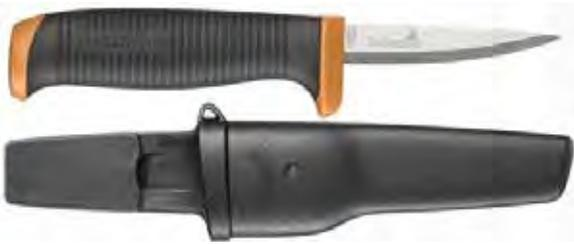
Handwerkermesser mit funktionellem Griff für Präzisionsarbeiten wie das Entfernen von Plastik-Grat, oder das Schnitzen an schwer zugänglichen Stellen. Durch die einzigartige Befestigungsweise an Knöpfen der Berufskleidung kann es nicht verloren gehen, ist zugleich aber leicht abnehmbar. Die Klinge aus 2,0 mm starkem Kohlenstoffstahl hat eine Härte von 58 bis 60 HRC.
