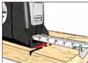
Mit den kombinierten Mess- und Markierkanten nehmen Sie Maß und übertragen es dann auf das Werkstück mit den gleichen Messkanten.
