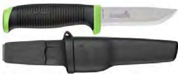
Handwerkermesser mit rutschsicherem Griff und sägezahnförmiger Klinge, welche für das Schneiden von festen Gegenständen oder Oberflächen, wie Seile oder Täue, die unter Spannung stehen, geeignet ist. Durch die einzigartige Befestigungsweise an Knöpfen der Berufskleidung kann es nicht verloren gehen, ist zugleich aber leicht abnehmbar. Klinge aus 2,0 mm starkem rostfreien Stahl der Härte 57-59 HRC.
