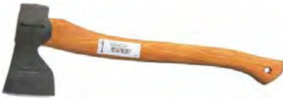
Sandgestrahlter und klar lackierter Schmiedekopf. Der Kopf ist am Stiel mit einer Aussparung versehen, damit die Hand bei Schneidearbeiten direkt über der Schneide gehalten werden kann. Geschwungener Stiel aus Hickoryholz.
