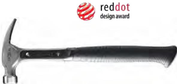
**Ergonomisch geformter Hammer, aus einem Stück geschmiedet für erhöhte Widerstandskraft, mit schwingungsdämpfendem Urethan-Einsatz. Die flache, kräftige Klaue ermöglicht eine gute Zugänglichkeit, ohne Spuren zu hinterlassen. Öffnung und Winkel der Klaue sind auf ein optimales Erfassen des Nagels ausgelegt. Der ergonomisch geformte Griff mit deutlichem Endstopp für einen sicheren Griff ist in zwei Größen erhältlich, Large und X-Large.**
