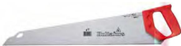
Standardsäge für den universellen Einsatz mit schlagfestem Griff aus ABS-Kunststoff und 45° - und 90° -Winkelführung. Der Griff ist ultraschallgeschweißt und das Sägeblatt besteht aus 0,8 mm dickem Stahl. Gehärtete Zähne mit Standard-2-Phasen-Schleifen für Effizienz und lange Lebensdauer. Die schmale Klingenspitze erleichtert den Zugang in engen Räumen und wenn etwas in der Mitte eines Brettes geschnitten werden muss.
