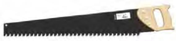
Säge zum Schneiden von porösem steinbasiertem Material. Die Klinge besteht aus 1,6 mm C75 Stahl und 34 Hartmetallzähne für Stabilität, Effizienz und lange Lebensdauer. Die Säge hat einen Holzgriff, der leicht zu reinigen ist.
