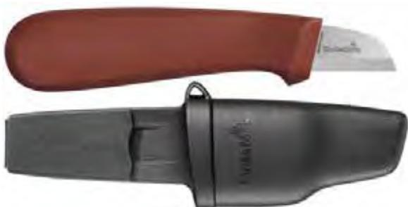
Die dünne Klinge, der Schliff und das Design des Griffes wurden für das Abisolieren optimiert. Durch die einzigartige Befestigungsweise an Knöpfen der Berufskleidung kann es nicht verloren gehen, ist zugleich aber leicht abnehmbar. Klinge aus 1,5 mm starkem japanischen Messer Stahl, einem auf 58-60 HRC gehärteten Kohlenstoffstahl.
