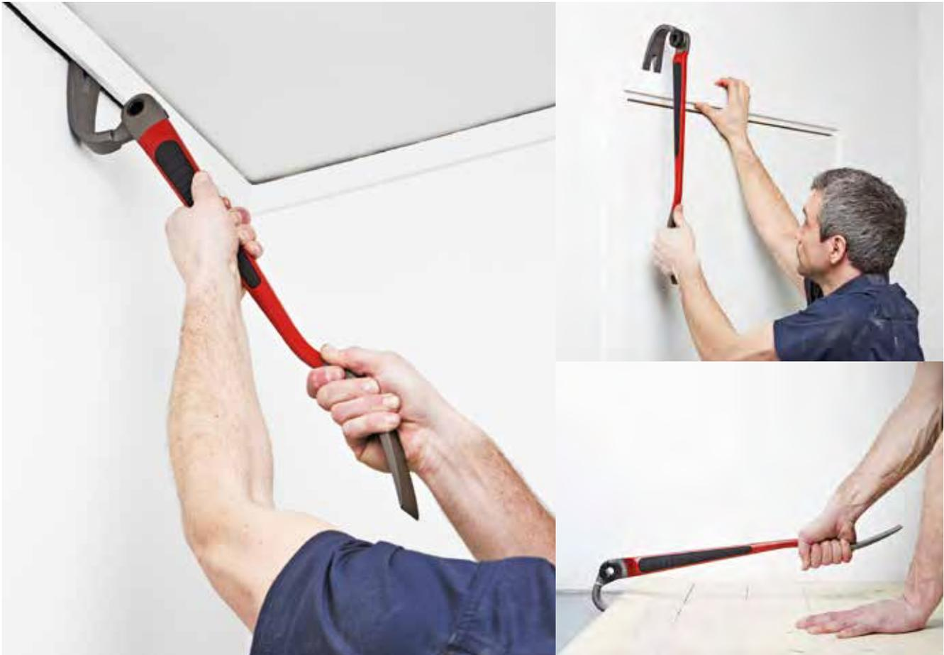
Nageleisen aus hochqualitativem Stahl mit einem ergonomischen, gummiumhüllten Griff. Ausgeprägte Klaue, in neun Positionen verstellbar. Breite Kontaktfläche und dünne Enden machen den Zugang zu kleinen Nischen möglich und minimieren das Risiko, das Werkstück zu beschädigen.
