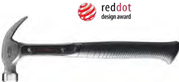
**Ergonomisch geformter Hammer, aus einem Stück geschmiedet für erhöhte Widerstandskraft, mit schwingungsdämpfendem Urethan-Einsatz. Die flache, kräftige Klaue ermöglicht eine gute Zugänglichkeit, ohne Spuren zu hinterlassen. Öffnung und Winkel der Klaue sind auf ein optimales Erfassen des Nagels ausgelegt. Der ergonomisch geformte Griff mit deutlichem Endstopp für einen sicheren Griff ist in zwei Größen erhältlich, Large und X-Large.**
